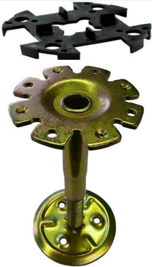
Пьедестал (стойка) для систем фальшпола **M16**, изготовлен из гальванизированной стали с плавно изменяемой высотой регулировки винтового соединения основы и верхней части пьедестала.
