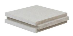
ТЕХНИЧЕСКИЕ ДАННЫЕ: Класс нагрузки и смещения 1С (2кH) $^1$ Основа плита гипсовая 38 мм Вес системы  $50 \text{ кг/ } \text{м}^2$ Стандартная высота пола 28-2000 мм<sup>3</sup> Толшина плиты 38,4 мм Размер плиты 594 х 594 мм Вес плиты 17,2 кг Верхнее покрытие БЕЗ ПОКРЫТИЯ Нижнее покрытие стальной лист 0,4 мм Сосредоточенная нагрузка в центре панели 2500Н Сосредоточенная нагрузка в середине края панели 2000Н
